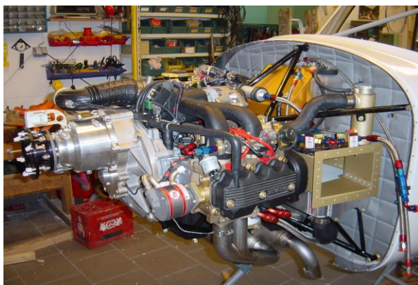
SUBARU EJ25 Package mit A40 PSRU
